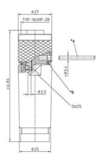
\*a Stift oder Schraubendreher als Montagehilfe pin or screwdriver as assembly tool
