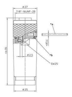
\*a Stift oder Schraubendreher als Montagehilfe pin or screwdriver as assembly tool
